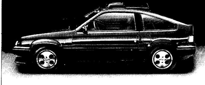
Der Honda Civic CRX ist die Fahrmaschine mit elektronischer Kraftstoffeinspritzung, 1,5-12-Ventil-Motor, 74 kW (100 PS), Spitze 190 km/h, von 0 auf 100 km/h 8,9 s. Testen Sie ihn. Sonderausstattung: Leichtmetallfelgen.
